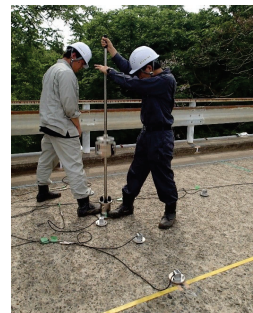
重錘落下(小型FWD)による振動試験
