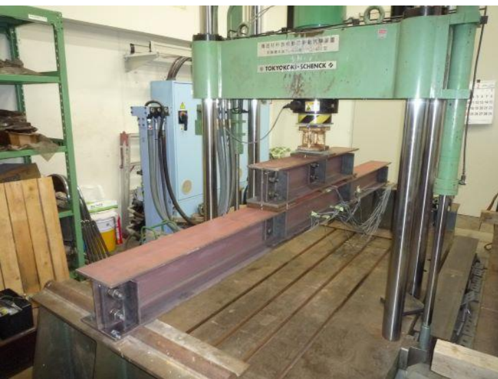
関西大学による CFRP補強鋼桁 の疲労試験 (坂野教授・石 川准教授の研究 室)
