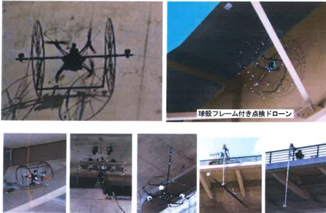
図 4.2.1 SIP インフラで開発された UAV・ロボット
