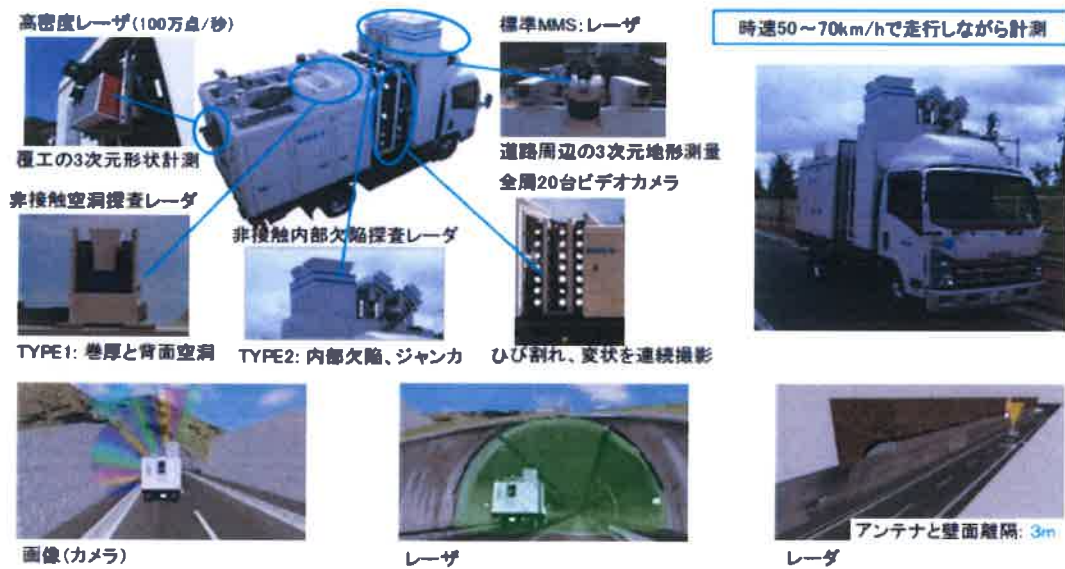
図 2.2.1 高速走行型トンネル点検と統合型診断システム (MIMM-R)
